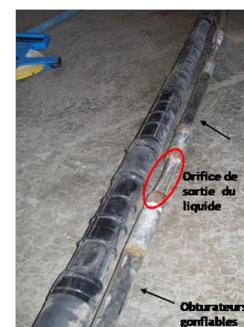
Détail d'un tube à manchette et de l'injecteur haute pression à double packers
