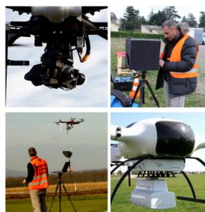
Conçu pour l'analyse de petites surfaces, ce drone permet de détecter des sources radioactives non contrôlées, une contamination potentielle ou de travailler dans des endroits contaminés où les doses sont dangereusement élevées.
