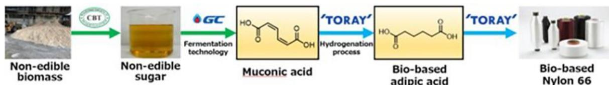
Fig 1. Procédé de fabrication du nylon 6,6 biosourcé
